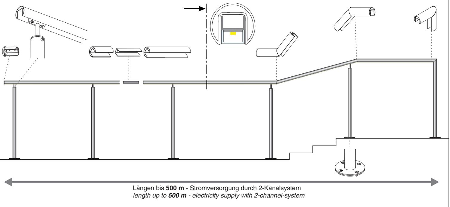
Längen bis 500 m - Stromversorgung durch 2-Kanalsystem
