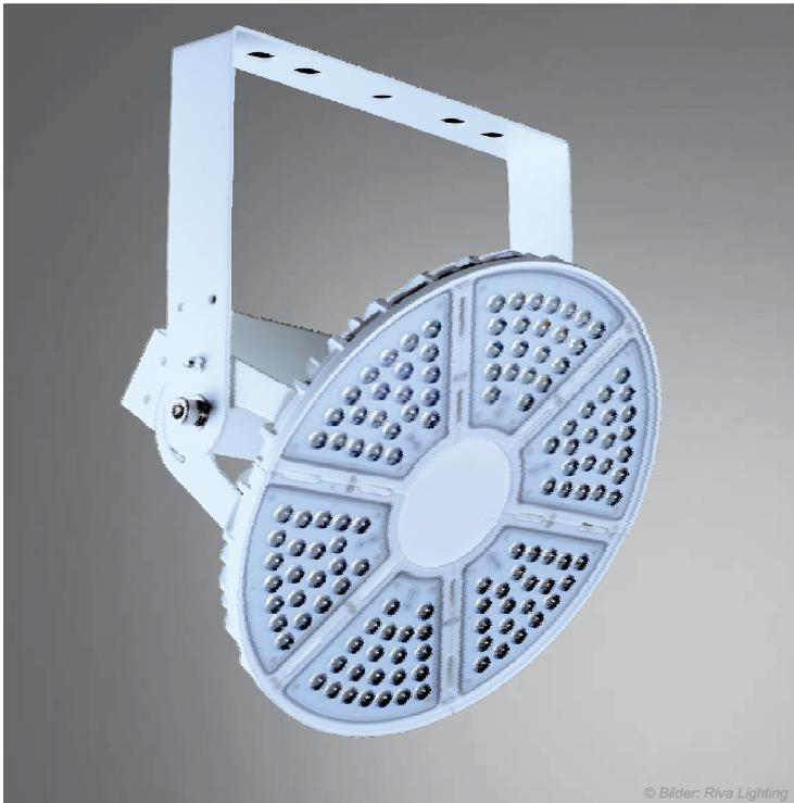
Mit einer Systemleistung von über 53.000 lm (Version mit 490 Watt) und dem Einsatz von Hochleistungsoptiken (30°, 60°, 100°), wurde diese neue Leuchtenserie speziell für hohe Behanghöhen (z.B. Hangars, Werfthallen, etc.) konzipiert. Durch den Einsatz einer Magnesium-Druckguss-Legierung als Kühlkörper ist diese leistungsstarke Leuchte erstaunlich leicht, sodass sie im Vergleich zu ähnlichen Produkten mit dieser Lichtstärke problemlos montiert werden kann.
